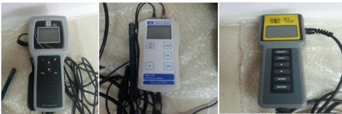
**Figura 9:** Instrumentos usados para medição dos parâmetros de qualidade de água: (a) Oxímetro, (b) pHmetro e (c) Salinómetro.
