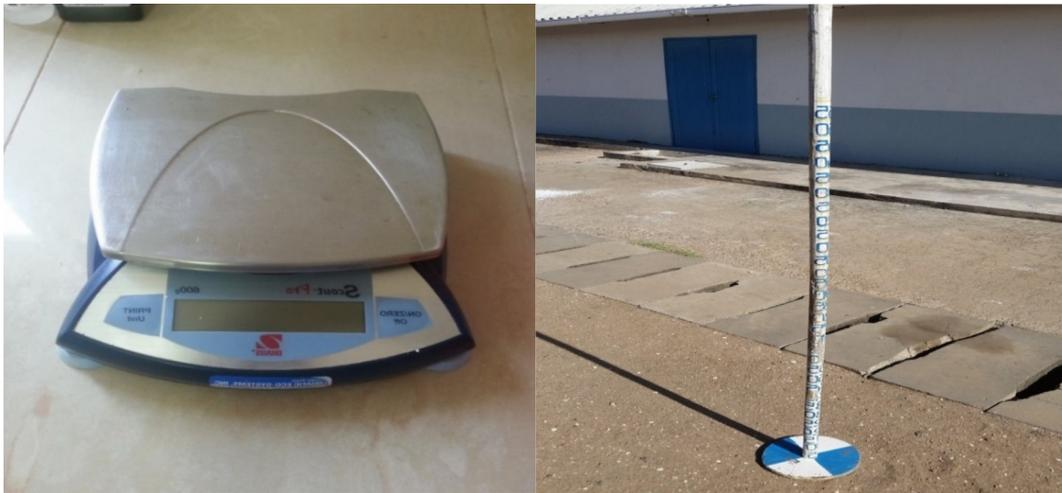
**Figura 8:** Balança usada para quantificação da ração e disco de Secchi usado para medição da transparência.
