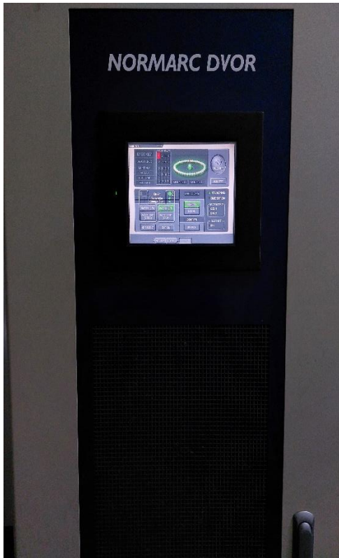
Figura do anexo XXIV- Equipamento DVOR (do autor)
