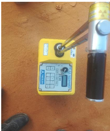
Figura 18: Teste da sub-base com Troxler;
