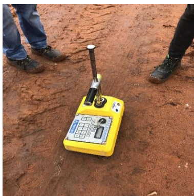
Figura 13: Teste do Subleito com Troxler;
