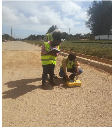
Figura 28: Compactação da base com cilindro compactador; Figura 29: Teste de da Base Com Troxler
