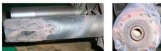
Figura 4.6: Imagem dos danos no bico de combustível da turbina a gás devido a um evento de retenção de chama
