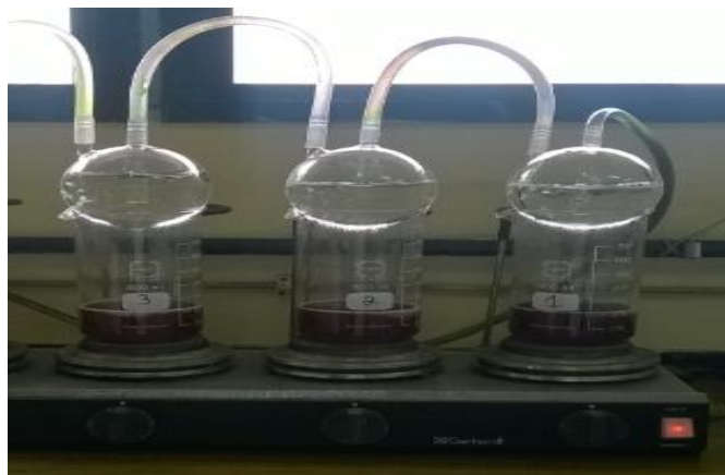
Figura 10: Copos contendo amostra e solvente em ebulição na placa de aquecimento
