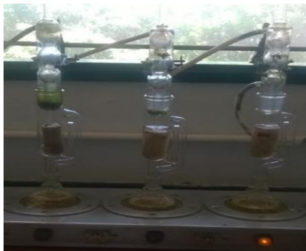
Figura 11: Sistema de extracção de óleo pelo método de Soxhlet
