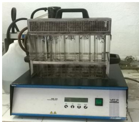
Figura 9: Tubos de digestão contendo amostra acoplados ao digestor
