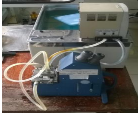
Figura 12: Refractómetro de Abbé acoplado a um banho termóstato
