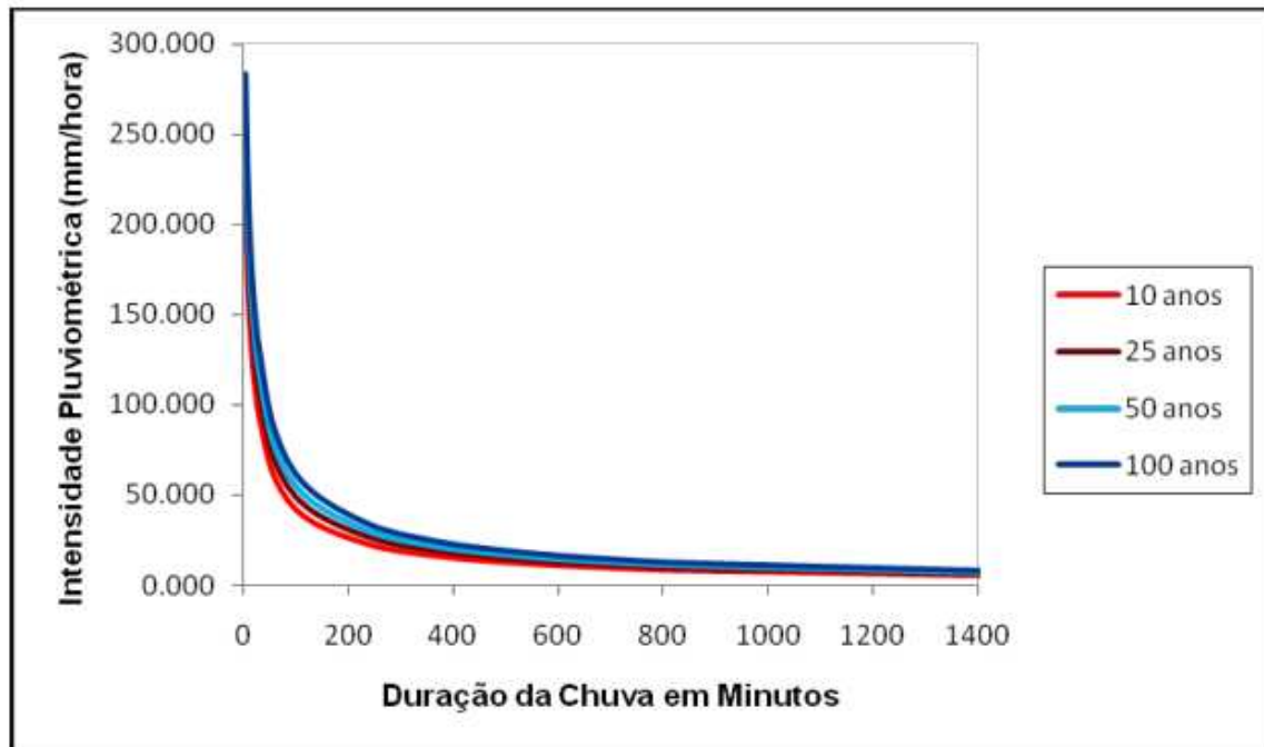
Figura 14: Exemplo de curva I-D-F com duração de 1 dia
