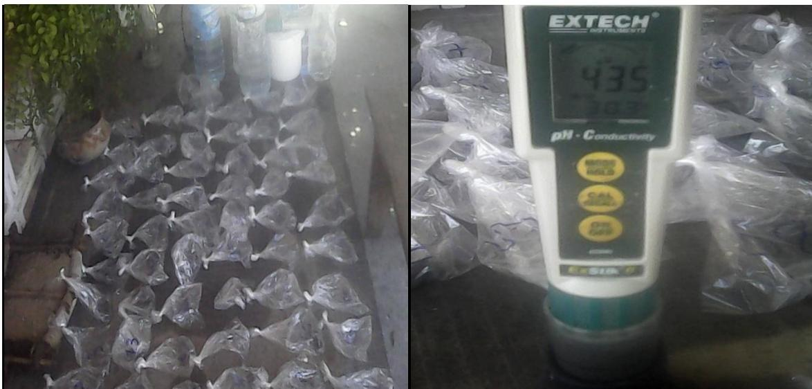
**Figura 3.4:** Mistura do extracto do solo com solo e água destilada (i). Medição da salinidade (ii)
