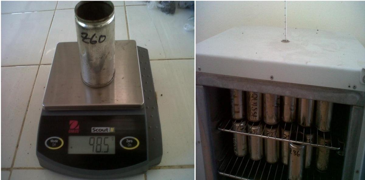
**Figura 3.5:**Medição do peso das amostras antes de estufa (i). Secagem das amostras (ii).
