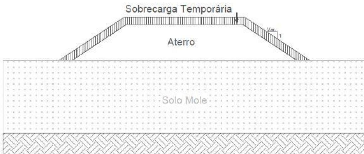
**Figura A.2-6: Secção típica de sobrecarga temporária para aceleração da consolidação.**
