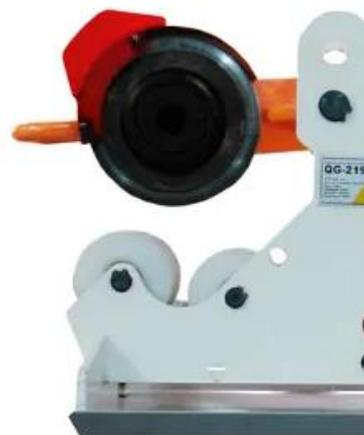
Figura A. 12-Máquina de cortar tubos.; fonte: (Atlasmaq)
