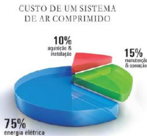
Figura 9-Diagrama de custos de um sistema de ar comprimido.; fonte: (MetalPlan, 2017)
