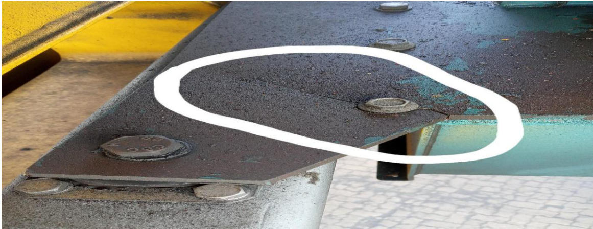
Imagem 4: Ilustração da tampa do tanque com racha (Fonte: Do autor).
