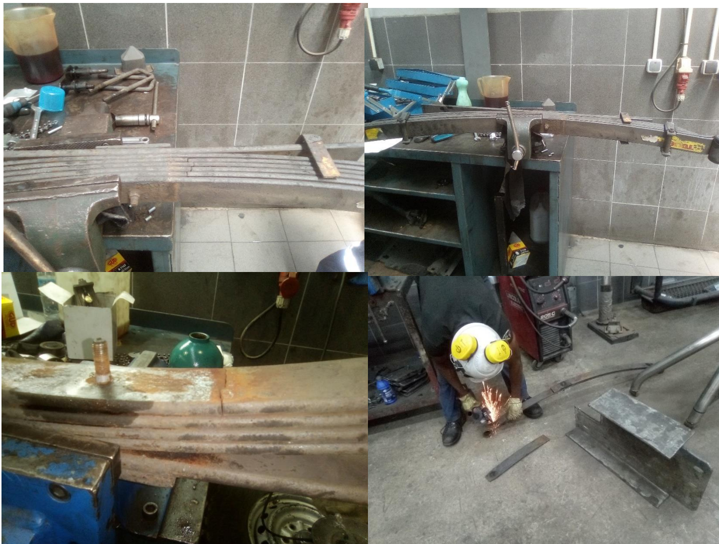
Figura 19 - Recondicionamento do feixe molas
