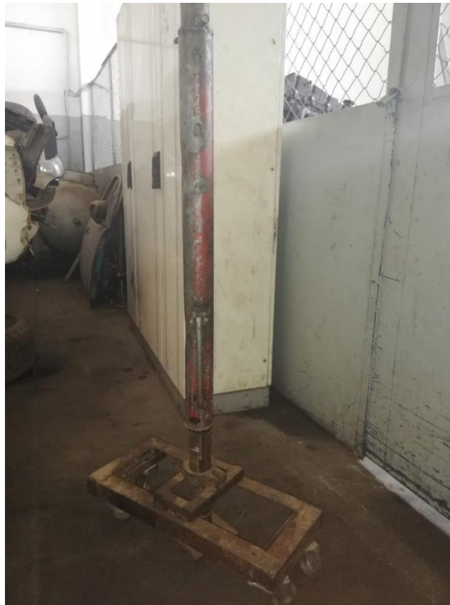
Figura 12 Adaptação em uso para a montagem e desmontagem da caixa de velocidade na oficina da técnica industrial JFS
