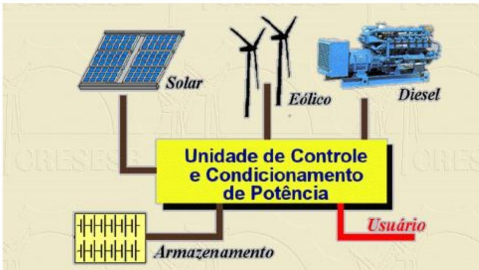
Figura 4.6: Esquema de sistema autônomo híbrido (Fonte: GEPEA, 2012)
