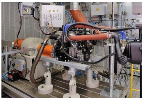
Figura 10: Instalação de um Dinamómetro de Correntes Parasitas [Fonte BURNETTI, 2012]
