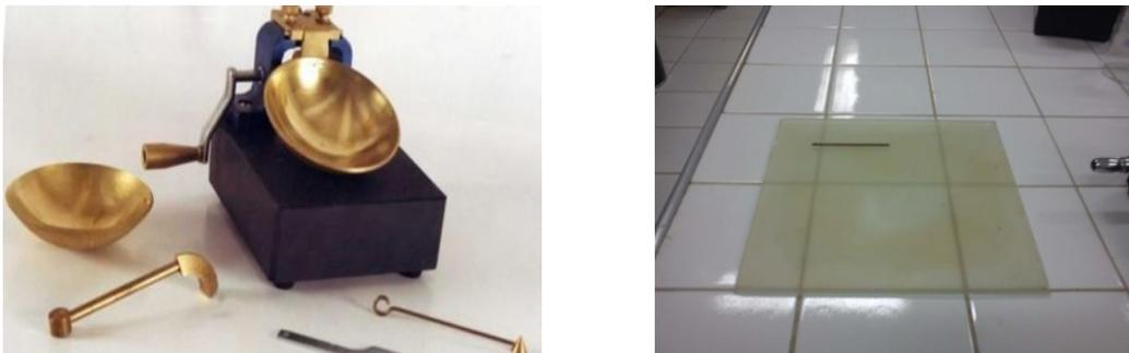
Figura 6. - *Aparelhos utilizados para a realização dos ensaios de consistência.* Fonte: O Autor
