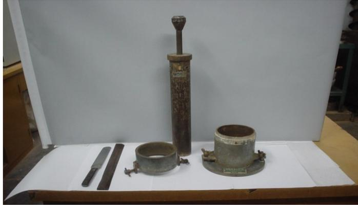
Figura 7. - Utensílios utilizados para a realização do ensaio de compactação.
