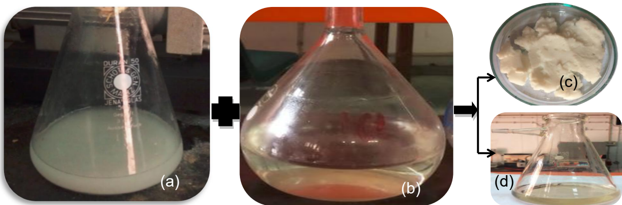
Figura 15: Processo de obtenção de cloreto de alumínio; (a): aluminato de potássio, (b): Acido clorídrico, (c): Cloreto de alumínio, (d): solução aquosa de cloreto de potássio.
