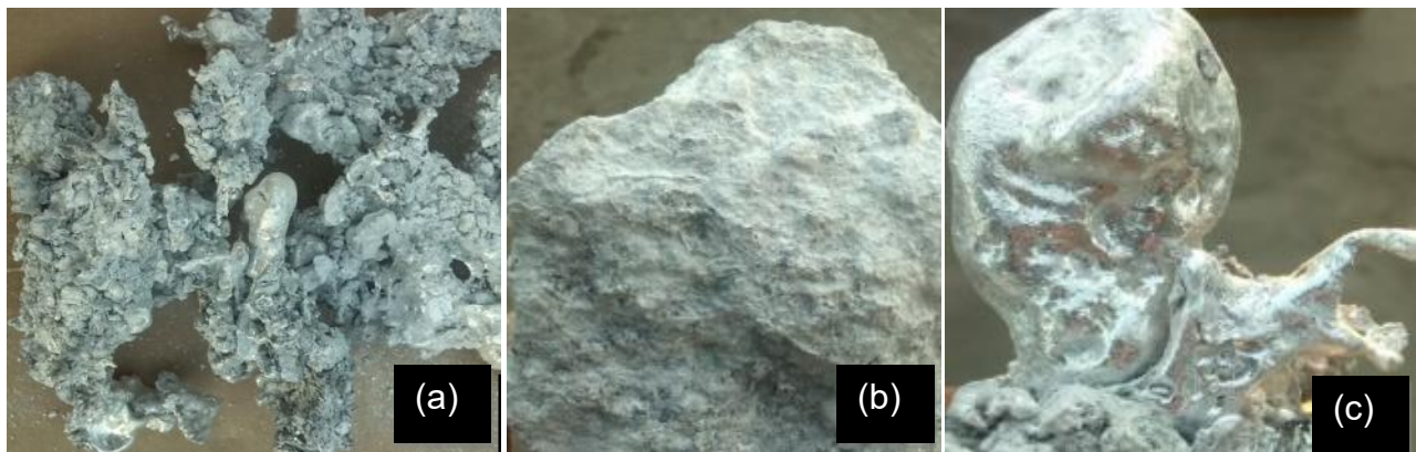
Figura 8: Resíduos de alumínio antes da moagem; (a): mistura de alumínio metálico e cinzas, (b) cinzas na forma de grânulo e pobre em alumínio, (c) mistura rica em alumínio
