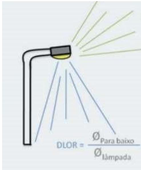
Figura: 4– Ilustração da distribuição do fluxo luminoso. Fonte: Manual de iluminação pública, EDP, 2016
