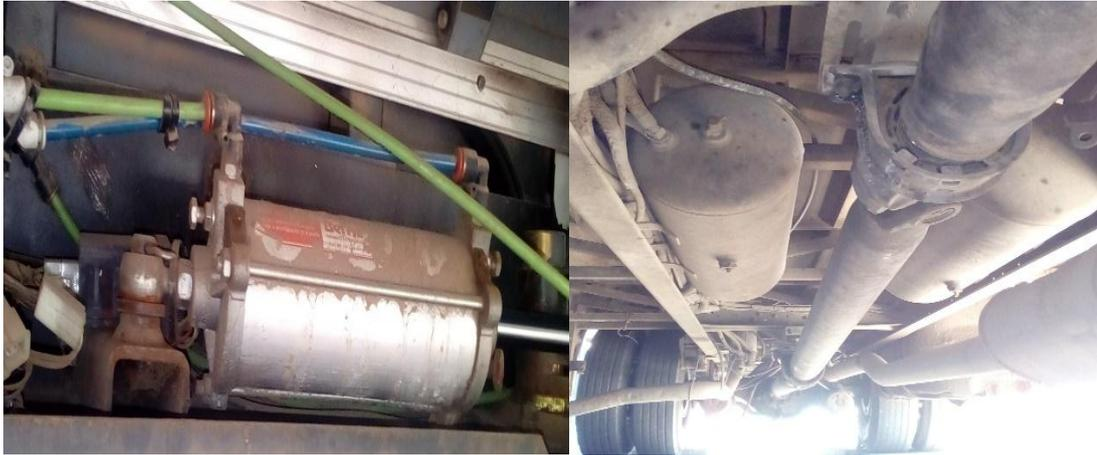
*Figura 2.9: atuador de portas (lado esquerdo) e reservatórios de ar comprimido.*
