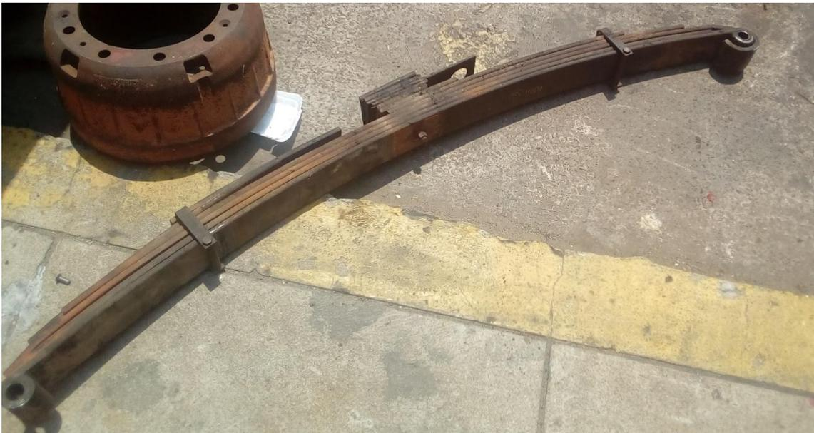
*Figura 2.6: Mola de laminas dianteiro de VW.*
