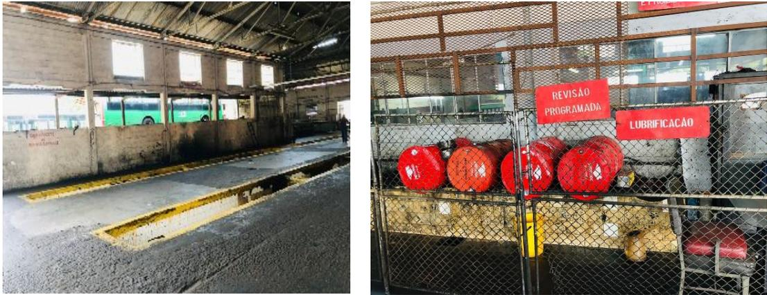
*Figura 3.4: Fossas para revisão programada e tambores de óleo de lubrificação de motores.*
