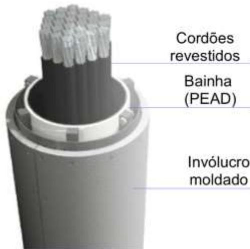
**Figura 18** - Sistema de protecção dos tirantes contra incêndio usando um invólucro moldado (material não inflamável e de baixa condutividade térmica) [8].
