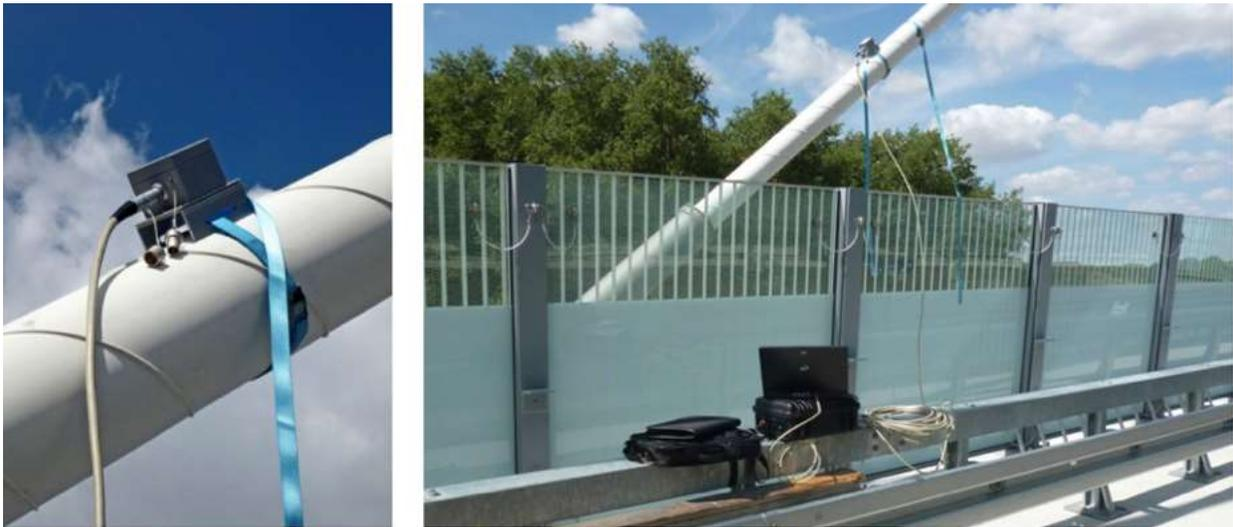
**Figura 37** - Acelerômetro tridimensional [7].
