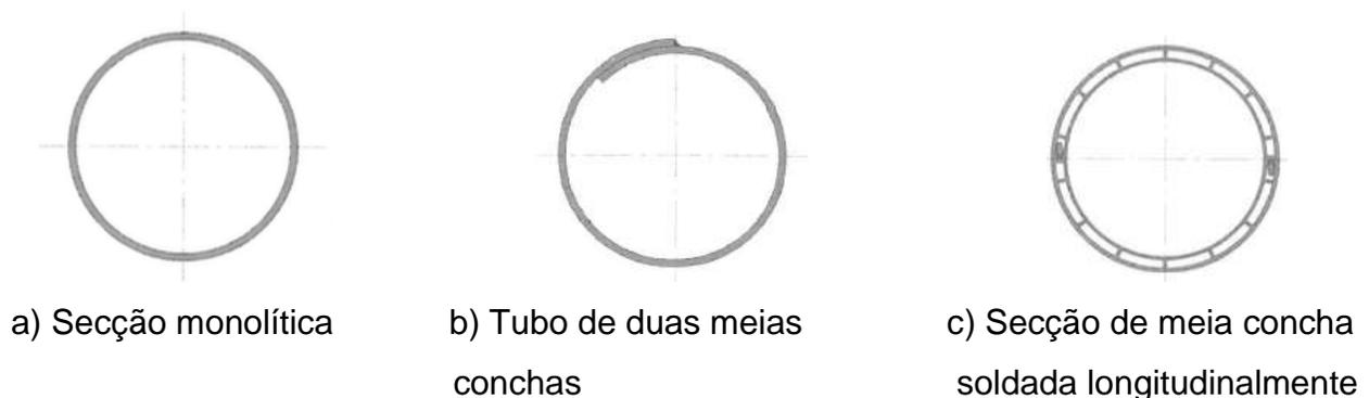
**Figura 19** - Tres opções diferentes de tubos de cabos [12].
