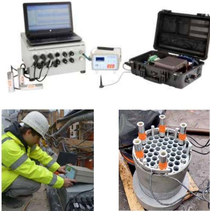
**Figura 40** – Equipamento para o teste ultrassônico [7].
