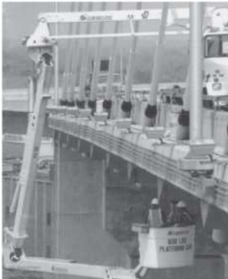
**Figura 24** - Acesso à zona de ancoragem na parte inferior do tabuleiro através do camião tipo Munck [13].
