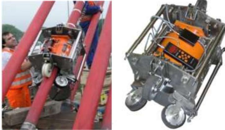
**Figura 41** - Instrumento para inspeção electromagnética dos tirantes [9].
