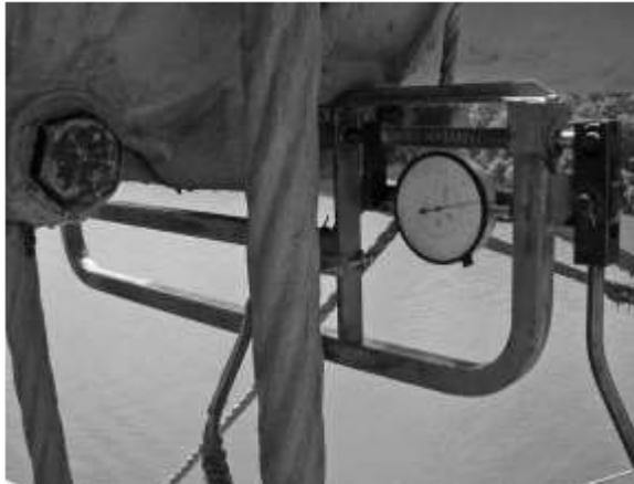
**Figura 34** - Extensómetro usado para medir o comprimento do parafuso com um grau de precisão de 0,002 polegadas [4].
