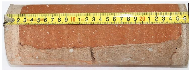
(f) Carote extraída na parede exterior ao nível do rés-do-chão (parede com espessura de 26 cm – um tijolo disposto na transversal)
