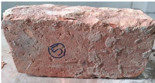
(e) Aspecto do provete 05 a ser submetido ao ensaio de resistência à compressão
