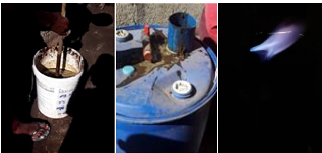
Figura 12. Mistura e enchimento do biodigestor e chama do Biogás
