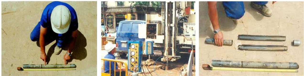
Figura 2 Ensaio SPT a) amostrador SPT; b) vista do amostrador desmontado; c) realização do ensaio (Fonte: Mesquita, 2013)
