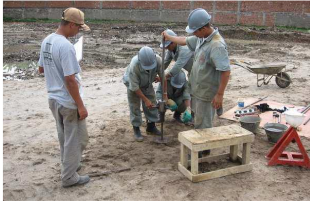
Figura 1 Ensaio de penetração dinâmica com penetrómetro ligeiro (Fonte: Mesquita, 2013)
