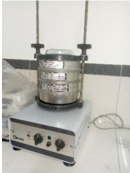
Figura 9. Mesa vibratória acoplada a peneiras usada para a classificação granulométrica dos finos de carvão vegetal
