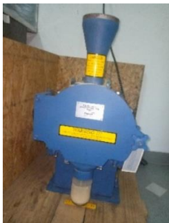
Figura 11. Moinho de facas do tipo Willey usada para moer as amostras
