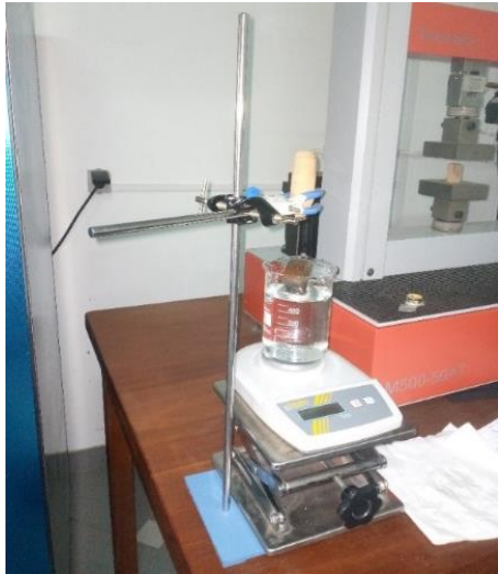
Figura 4. Determinação do volume verde pelo método de balança hidrostática.
