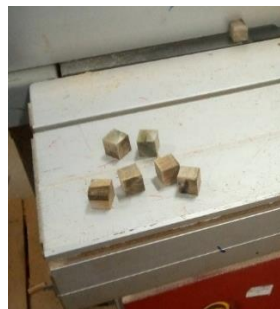
Figura 3. Esquema de obtenção de corpos de prova de 2x2x2cm no segundo disco
