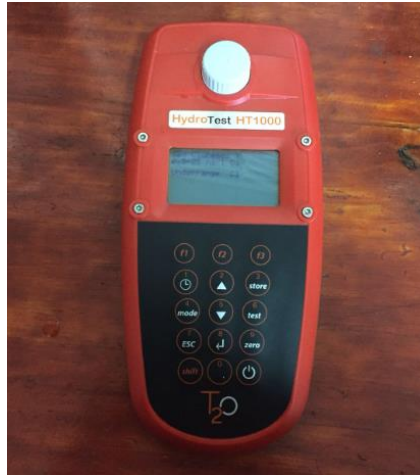
Figura 3.4: HydroTest HT1000 , instrumento com que se mediu a cor, cloretos, fluoretos, dureza, DQO e DBO.
