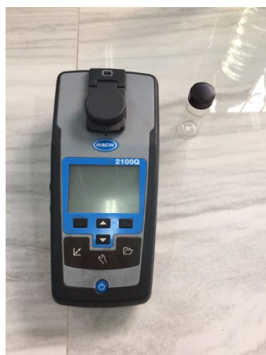
Figura 3.5: Turbidimeter 2100Q , instrumento com que foi medida a turbidez.
