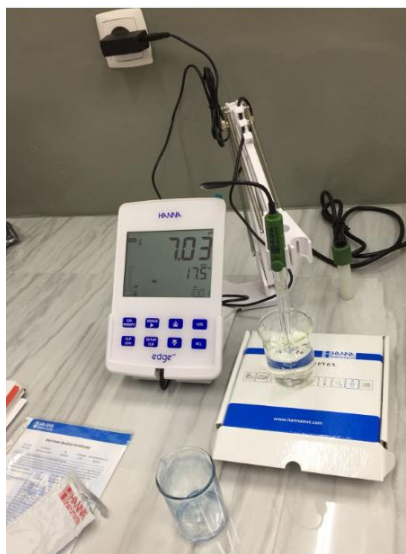
Figura 3.6: HI-2002 Edge pH Meter, instrumento usado para a determinação de pH.
