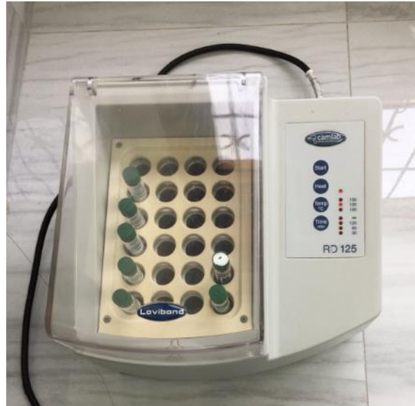
Figura 3.7: Thermoreactor RD 125 | Digester Block . Lovibond , instrumento usado para a determinação do nitrogénio total.
