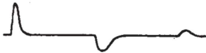
**Figura 22.** Ecograma típico de um defeito de isolamento [13]
