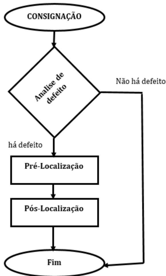
Figura 10. Fluxograma dos passos para detecção de avarias [Autoria Própria]
