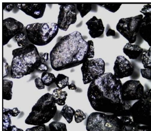
Figura 2: Ilmenite ( FeTiO_3 ) é um óxido natural de ferro e titânio; de magnetismo fraco; de cor preta com brilho submetálico à metálica (Cairncross, 2004).
