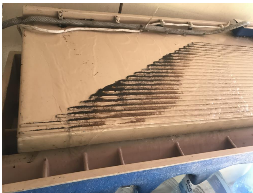
Figura 27: Perfil de separação pôs atingir o regime de separação gravítica na Mesa Wilfley (Lab. Geologia-Feng).
