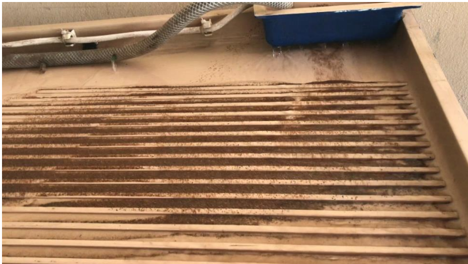
Figura 25: Zona de alimentação antes do ajuste dos parâmetros de operação da mesa Wilfley (Lab. Geologia-Feng).
