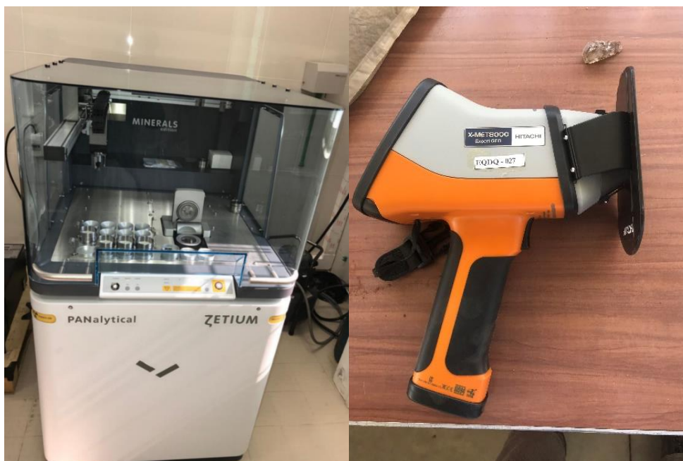
Figura 8: A esquerda tem-se o XRF de mesa; a direita tem-se o XRF portátil (Lab. de química - INAMI)
