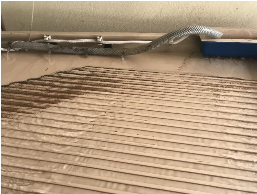
Figura 26: Zona de alimentação depois do ajuste dos parâmetros de operação na mesa Wilfley (Lab. Geologia-Feng)
