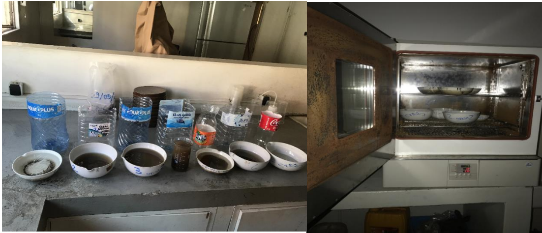
Figura 28: A esquerda, produtos obtidos na concentração com a mesa Wilfley; a direita estufa Yamato DVS602 ( Lab. Geologia - FENG ).
