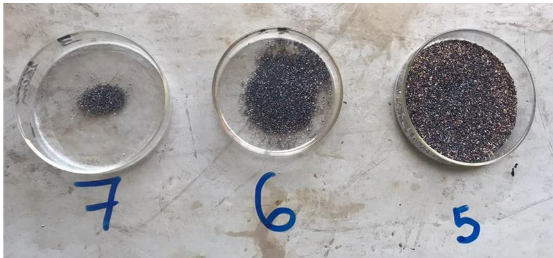
Figura 43: Resultados das saídas da zona de concentração na mesa Wilfley.
