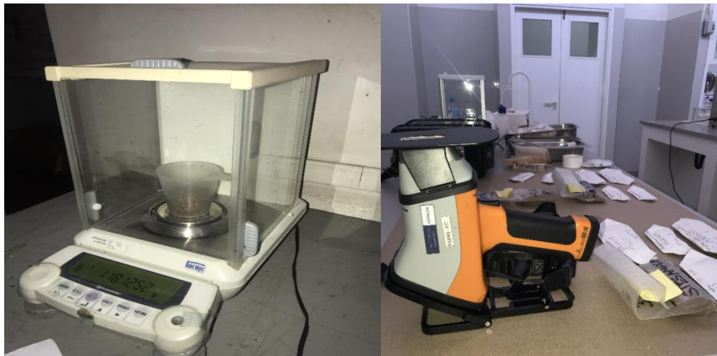
Figura 23: A esquerda temos a balança analítica SHIMADZU AUV220 (Lab. Geologia-Feng); A direita temos XRF-Portátil X-MET8000 (INAMI).
