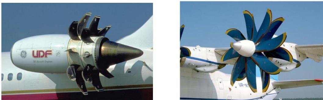
Figura 12: (a) Propfan impulsora desenvolvida pela General Electric; (b) Propfan Progress D-27 de configuração tratora utilizada no Antonov An-70. Fonte: (Fernandes et al,2008).
