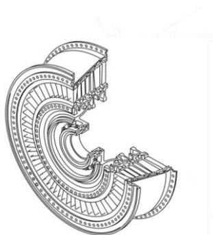
Figura 25: Esquema da turbina de baixa pressão (LPT). Fonte: (CFM 2003).
