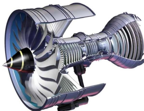
Figura 9: Motor turbofan Rolls-Royce Trent 1000. Fonte: (Fernandes et al, 2008).
