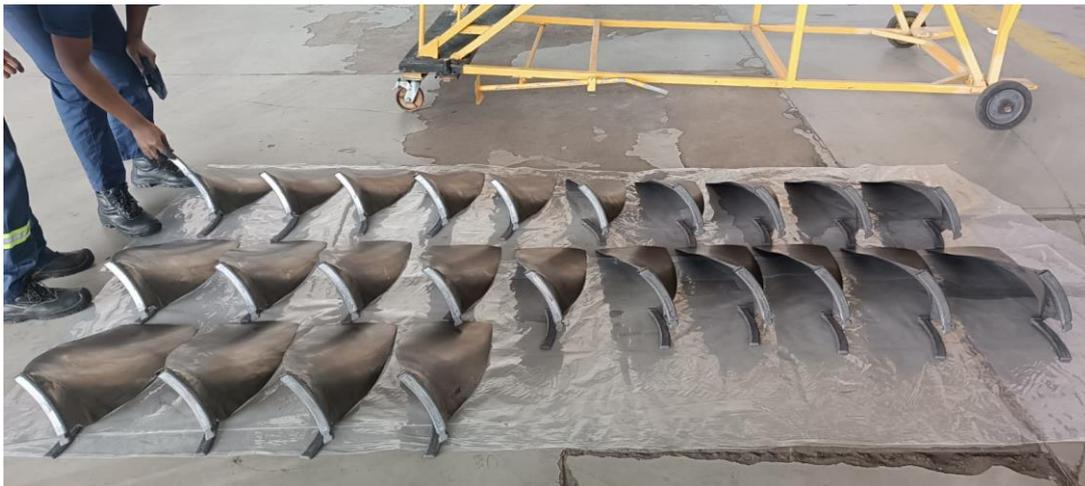
*Figura 45: Fan blades removidas para lubrificação e secagem. Fonte: (Autor).*
