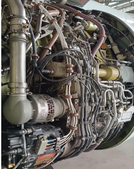
Figura 29: Vista do Accessory gear box-AGB no motor. Fonte: (Autor).
