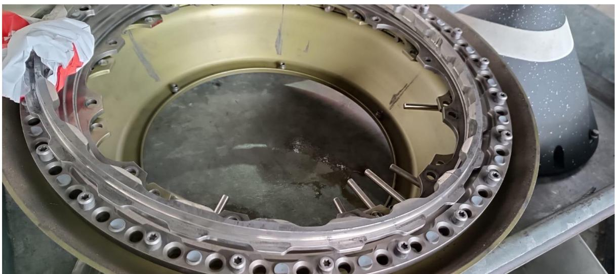
Figura 42: Parafusos de equilíbrio de peso do Spinner Cone traseiro. Cone removido durante os trabalhos de manutenção. Fonte: (Autor)
