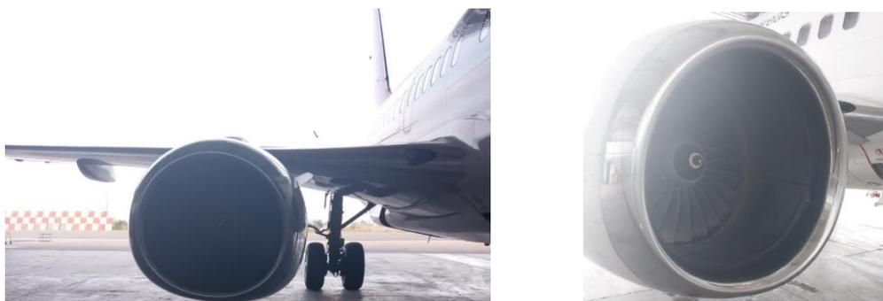
Figura 39: Motor modelo CFM56-7B da aeronave C9-BAQ. Fonte: (Autor)
