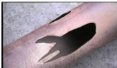
Figura 15 – Exemplo de desgaste de um tubo. Fonte: MILLS, 2004
