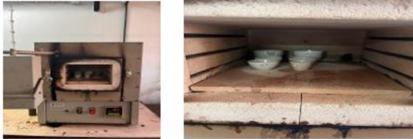
Figura 10: a) Mufla; b) Cadinhos dentro da mufla.
