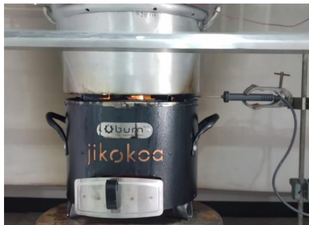
Figura 12: Equipamento utilizado para realização do teste de ferver de água.
