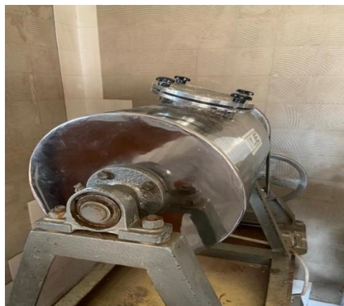
Figura 10: Moinho de bolas utilizado no teste de friabilidade.
