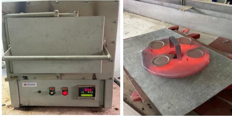
Figura 8: Mufla e cadinhos utilizados na determinação do teor de voláteis.
