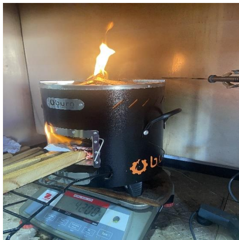
Figura 2: Equipamento utilizado para o teste de índice de combustão.
