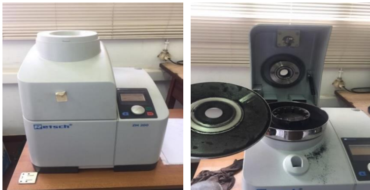
Figura 5: Moinho ultra centrífugo usado para a moagem das amostras.
