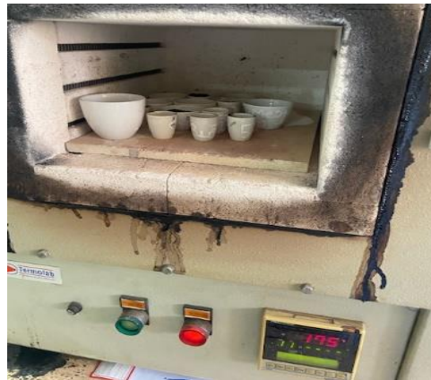
Figura 7: Mufla e cadinhos utilizados na determinação do teor de cinzas.
