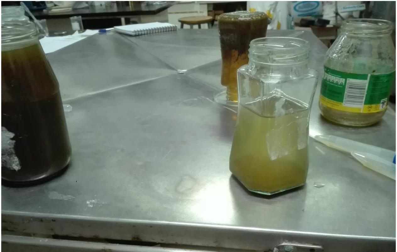
Figura II: Ilustração do método de sedimentação simples
