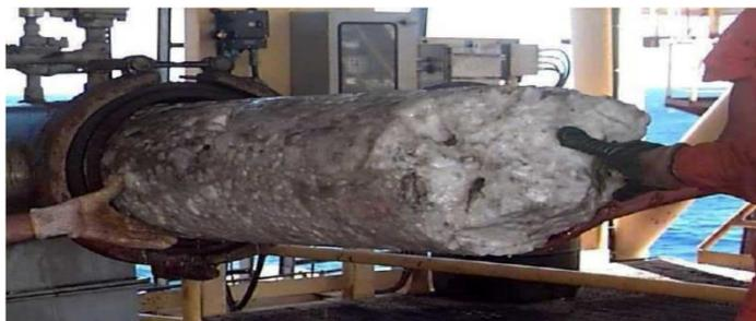
*Figura 1: Plugue de hidrato sendo retirado de uma tubulação de gás pelo receptor de “pig”. (Vaz, 2008)*
