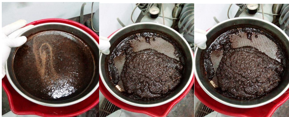
Figura 7: Lavagem e filtração da mistura de licor negro e celulose.
