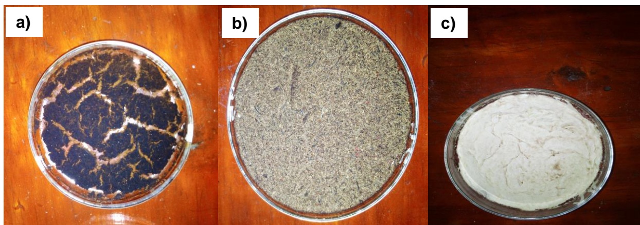
Figura 10: Celulose obtida após o branqueamento e secagem. a) Material seco após a extracção da lignina sem nenhuma lavagem; b) Material seco após a extracção da lignina e três lavagens; c) Material seco após a extracção da lignina e branqueamento.
