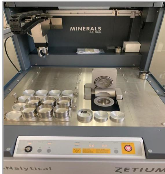
**Figura 12:** Aparelho de fluorescência de raios-X.
