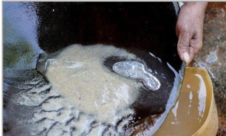
**Figura 1:** Operação de extracção de ouro usando Hg. (Fonte: ONU-NEWS)
