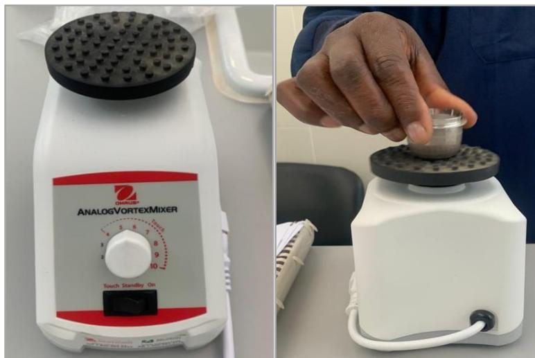
**Figura 9:** Vibrador automático na mistura de amostra e fundente.
