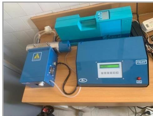
**Figura 14:** Analisador de mercúrio versátil com pirolisador.
