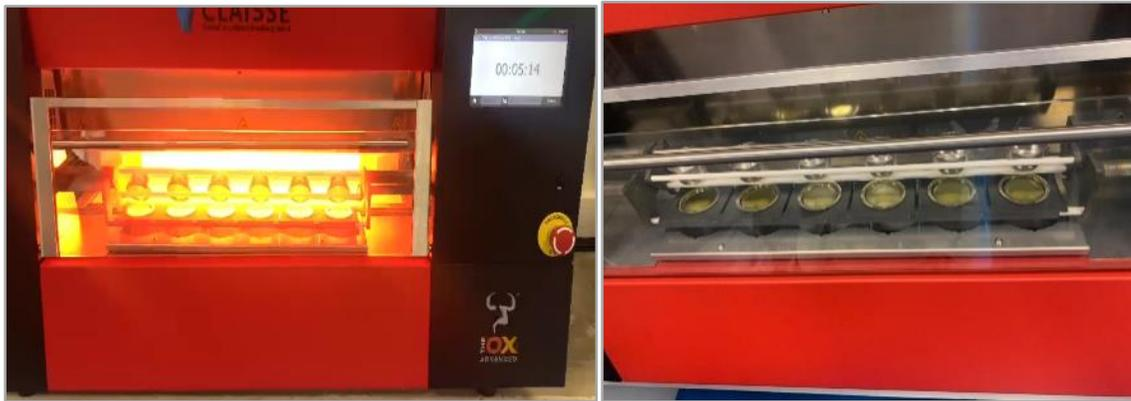
**Figura 10:** Processo de formação dos discos fundidos na máquina de fusão.
