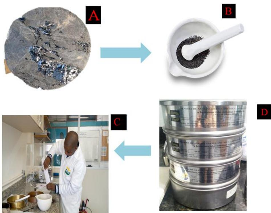
Figura 3: Procedimento de preparação laboratorial de amostras
