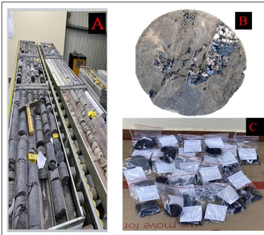
Figura 2: Procedimento padrão de selecção e colecta de amostras em um testemunho de sondagem.
