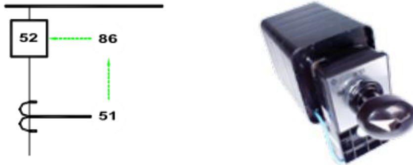
Figura 10: Representação do relé de bloqueio em esquemas unifilares e uma foto do mesmo
