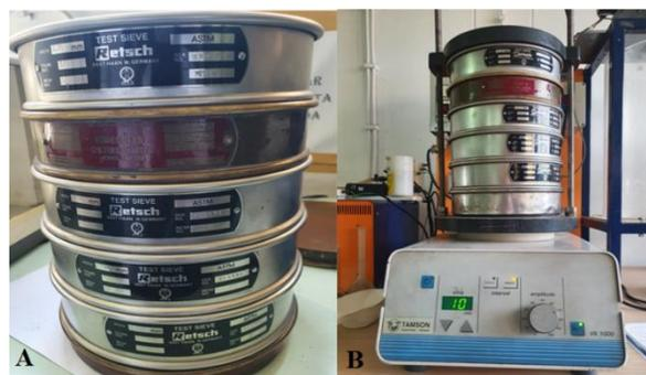
Figura 11: A – Série de peneiros; B – Peneiro vibratório – constituído pelo vibrador, na base, e a série de peneiros, que é colocada sobre vibrador
