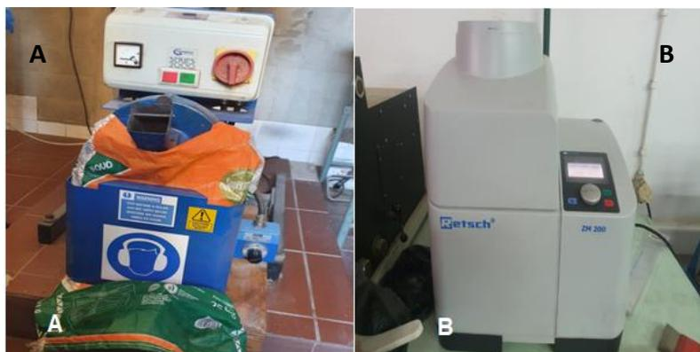
Figura 10: A- Moinho de facas; B- Moinho ultracentrífugo
