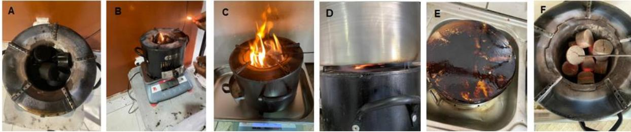
*Figura 26: Imagens de combustão: A) Briquetes embebidos de querosene no combustor; B) Ignição da querosene; C) Ignição dos briquetes; D) Emissão de fumo branco durante a fervura; E) Aderência de óleo acastanhado na panela; F) Formação de cinzas a volta dos briquetes.*
