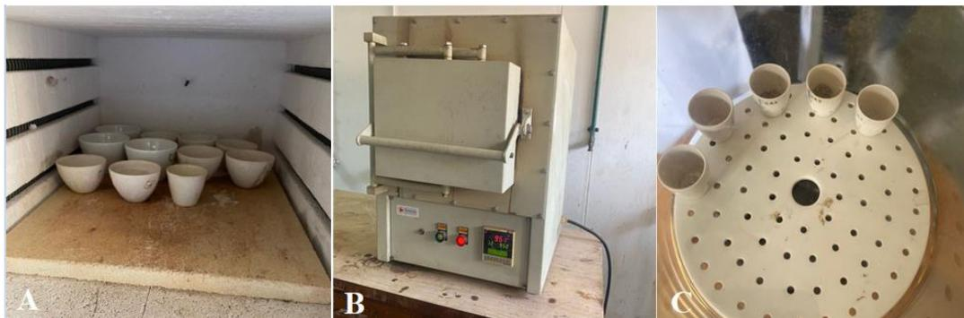
Figura 15: Determinação do teor de cinzas: (A) Cadinhos na mufla; (B) Mufla em funcionamento; (C) Cadinhos no dessecador.
