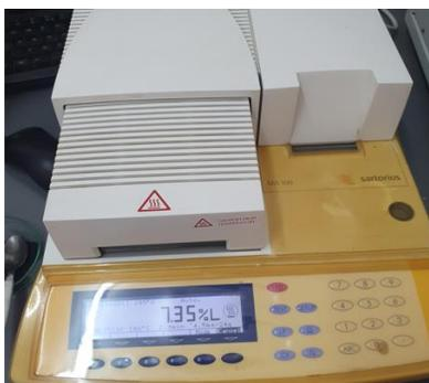
*Figura 9: Analisador de humidade.*
