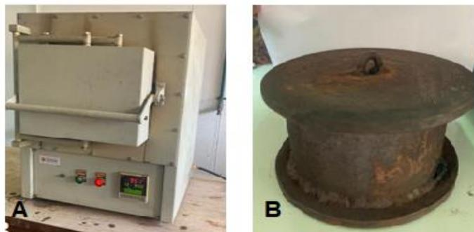
Figura 12: Equipamento usado para realização da carbonização; A – Mufla; B – Reactor de metal.
