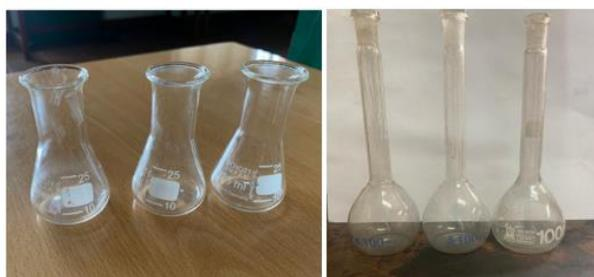
*Figura 14: Erlenmeyers e balões volumétricos usados na determinação da densidade a granel.*
