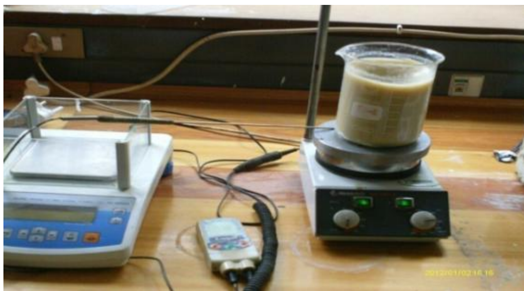
Figura 8: Bentonite em tratamento químico para remover as formas polimórficas da sílica.
