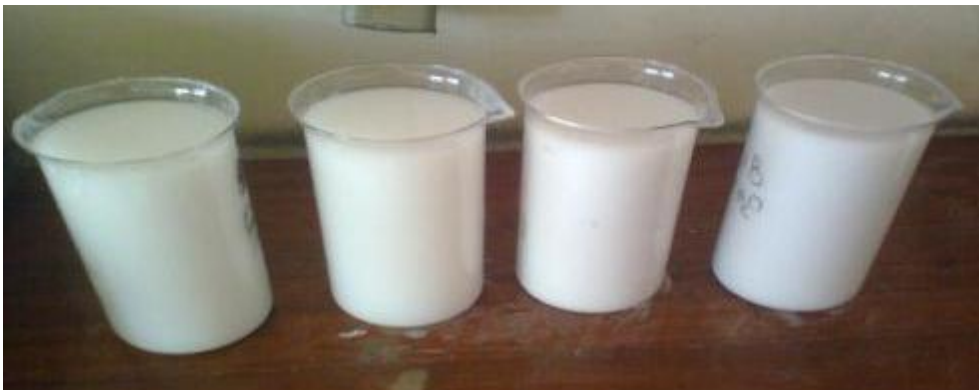
Figura 7: Suspensão aquosa da bentonite deixada repousar durante 24h para investigar a sedimentação selectiva (lei de Stokes)
