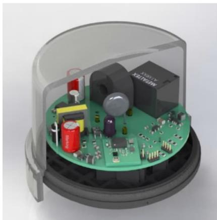
*Figura 13 – Unidade de comando de um SIT da marca liteleds*
