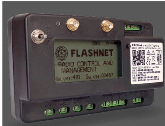
Figura 14 – Unidade de controlador de um SIT da marca inteliLIGHT
