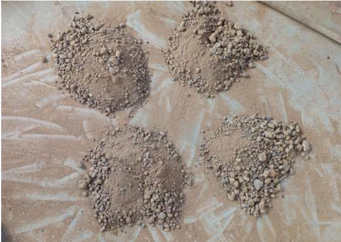
A1- 11: Separação manual da amostra para realização de ensaios-Fonte: Adaptado pelo autor
