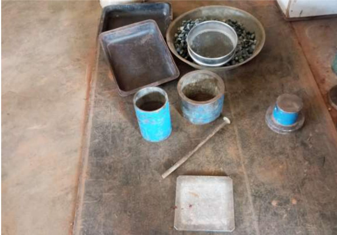
A1- 7: Equipamentos usados no ensaio de ACV e 10% Fact-Adaptado pelo autor
