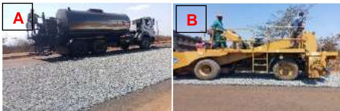
Figura 37: Equipamentos A–Camião espargidor; B–Espalhadeira–Fonte: Adaptado pelo autor
