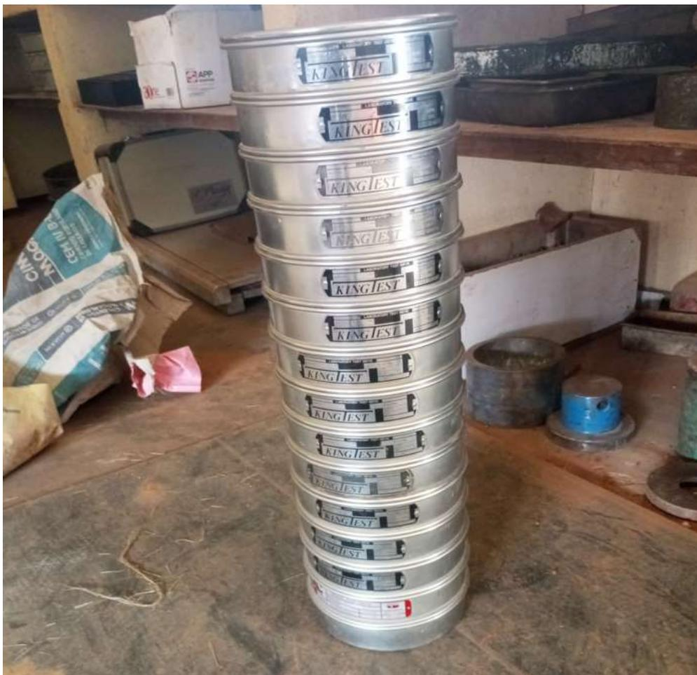
A1- 2: Peneiros usados no ensaio de análise granulométrica-Fonte: Adaptado pelo autor
