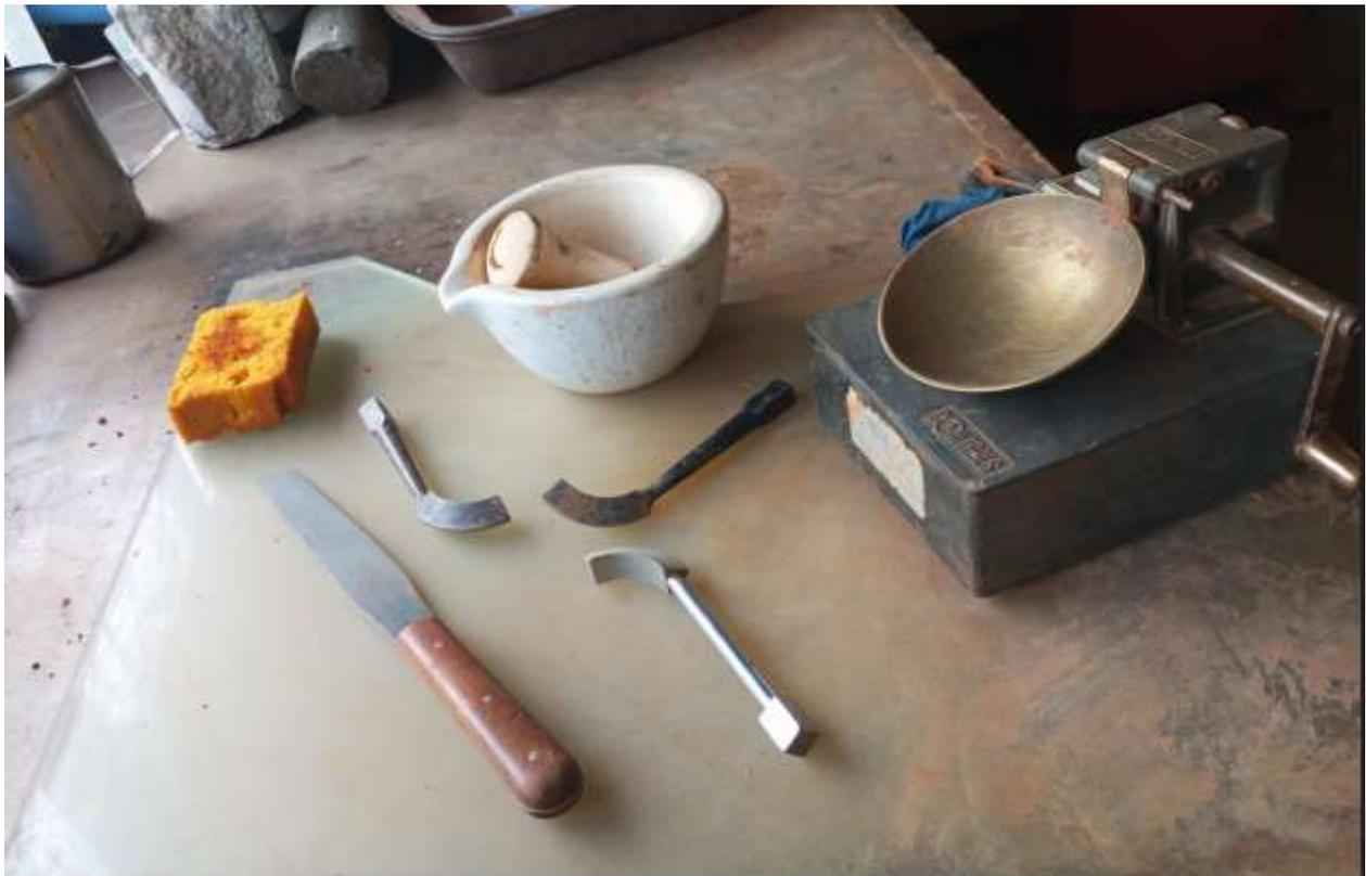
A1- 5: Equipamentos utilizados no ensaio limites de Atterberg-Adaptado pelo autor
