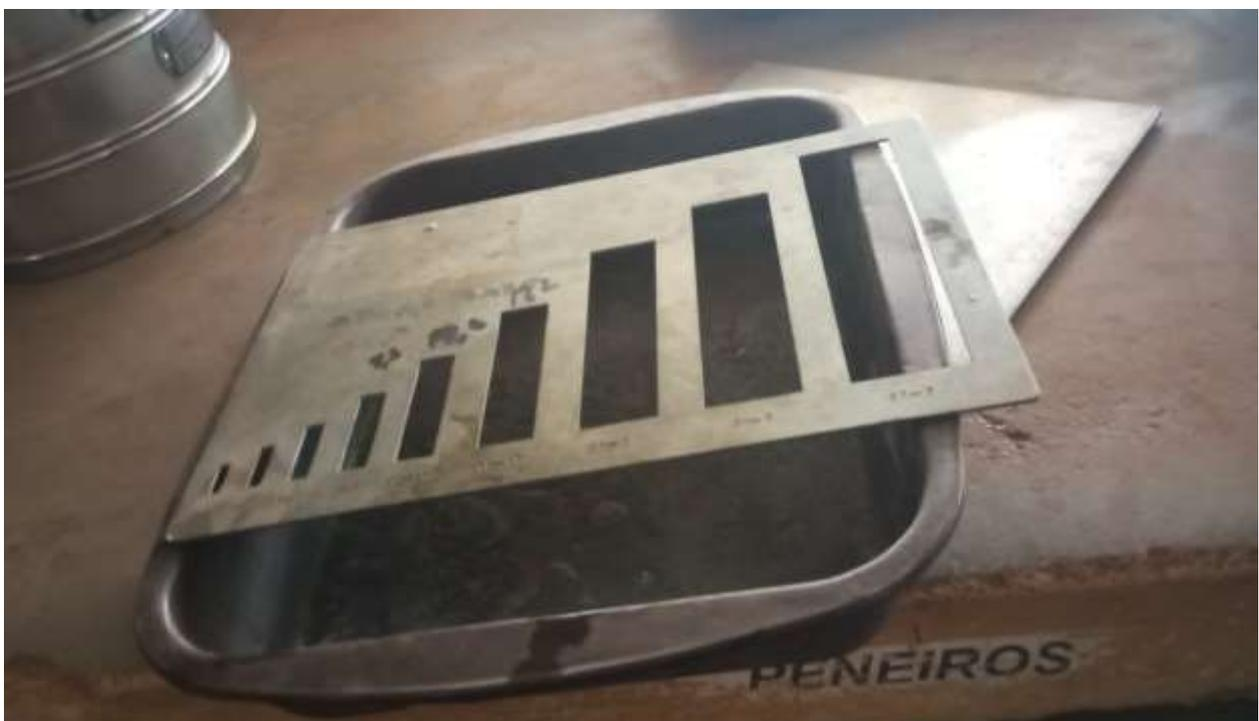
A1- 6: Medidor usado no ensaio de índice de lamelação
