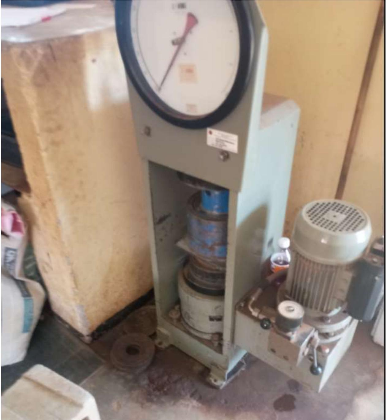
A1- 13: Esmagamento de brita na prensa no ensaio de ACV ou 10% Fact-Adaptado pelo autor
