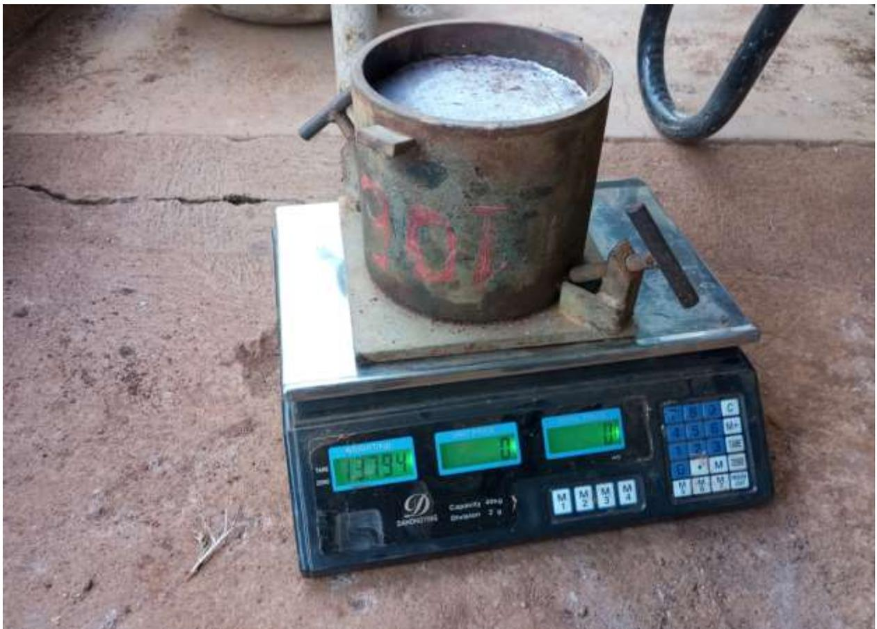
A1- 4: Pesagem do molde com solo compactado para imersão-ensaio de CBR-Adaptado pelo autor
