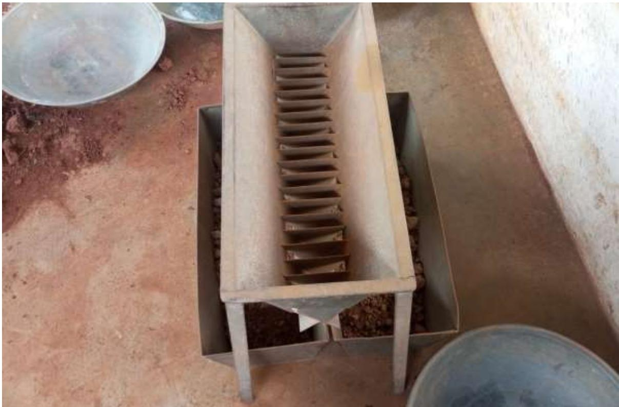
A1- 12: Esquartelamento da amostra para realização de ensaios-Fonte: Adaptado pelo autor
