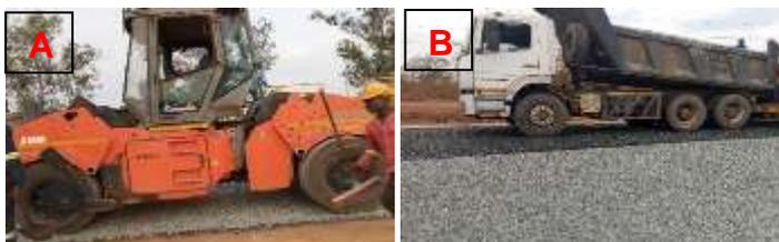
Figura 38: Equipamentos: A–Compactador pneumático; B–Camião basculante–Fonte: Adaptado pelo autor
