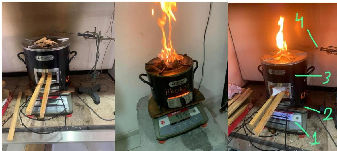
*Figura 11- Equipamento utilizado para os ensaios de índice de combustão*
