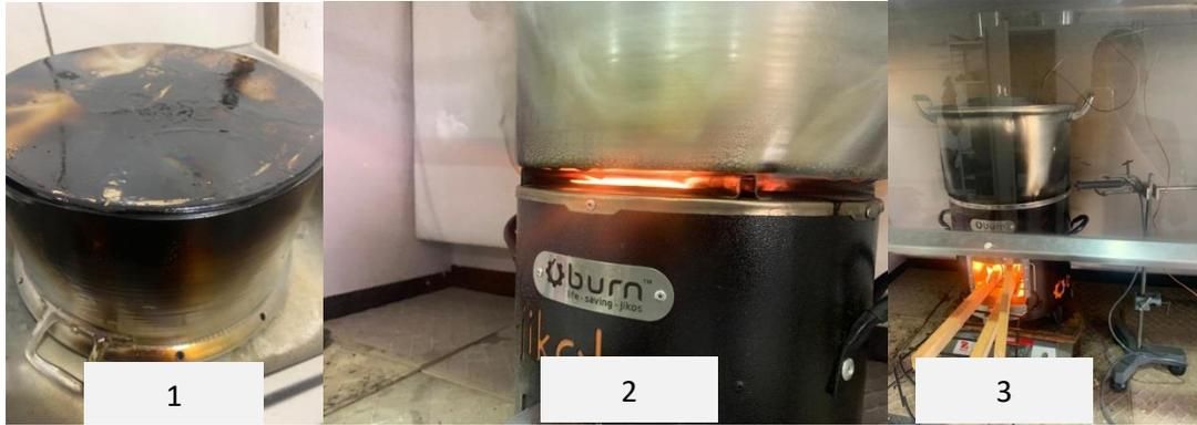
*Figura A1.1 - panela suja pelos briquetes 1; fumaça do briquete- 2, panela suja pela lenha - 3*
