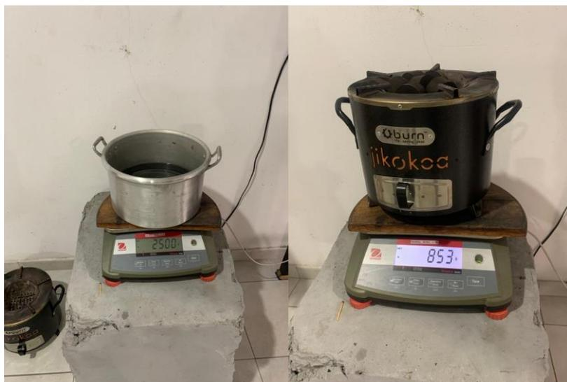
*Figura 12- Medição da panela, água, fogão e combustível*
