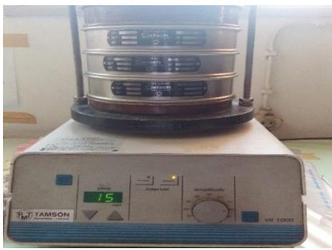
Figura 6- Peneiração no peneirador vibratório
