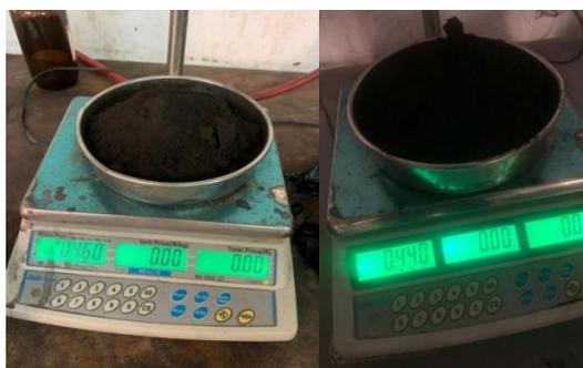
Figura 18 - Massa da biomassa após a carbonização
