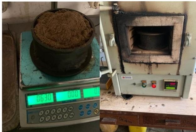
*Figura 7 - Biomassa no reactor, mufla para a carbonização*
