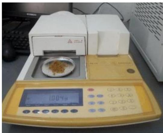
Figura 4- Analisador de umidade
