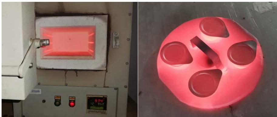
Figura 8- Cadinhos de níquel retirados da mufla
