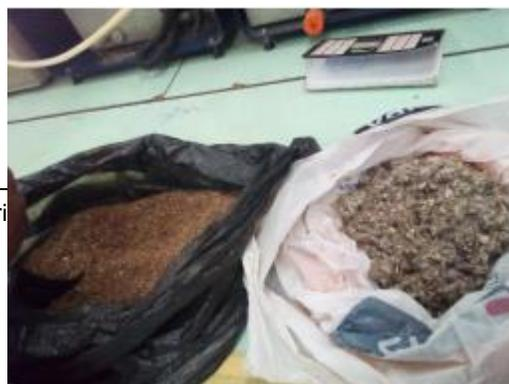
Figura 2 – Resíduos de processamento de algodão sem fibras a esquerda e com fibras a direita
