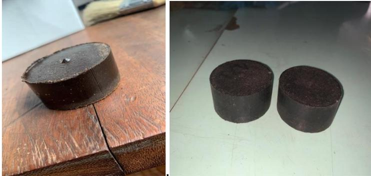
*Figura 16 - Briquete não carbonizado a esquerda e carbonizados a direita produzidos com a humidade ideal*
