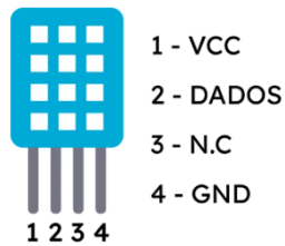
Figura 23: Pinagem do sensor DHT11.
