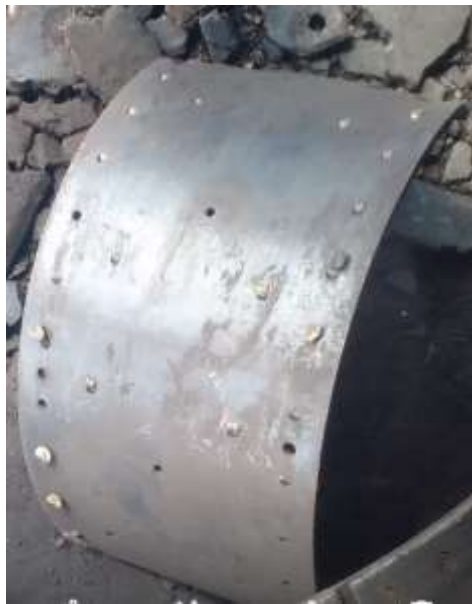
Figura 2: Sapata de freios.
