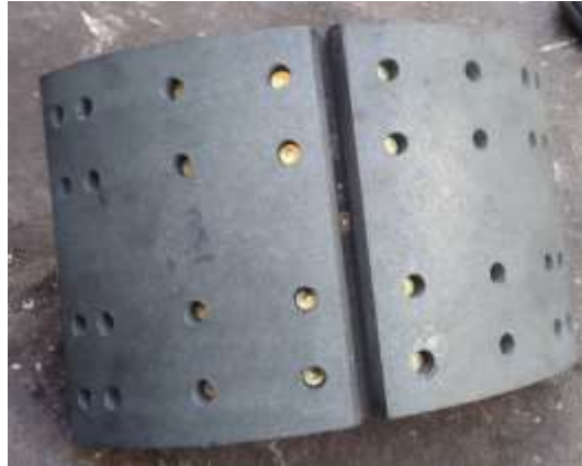
Figura 3: Lonas de freio rebitadas nas sapatas.
