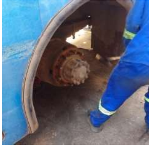
Fig14b: Extracção do tambor de freio usando a maretas.
