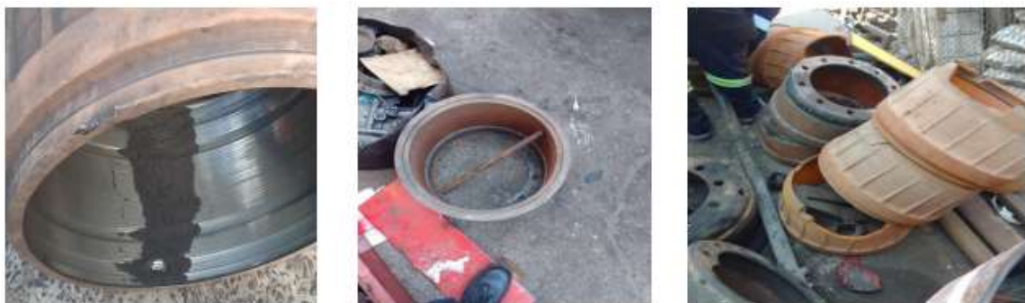
Fig14c: danos causados pela extracção manual do tambor do freio
