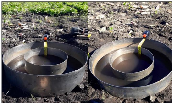
**Figura 5:** Determinação da infiltração da água no solo utilizando o infiltrômetro de duplo anel.
