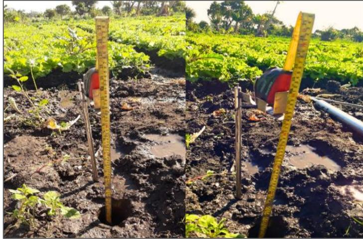
**Figura 4:** Determinação da permeabilidade em campo (até quase 2 metros de profundidade) utilizando o método *auger hole*.
