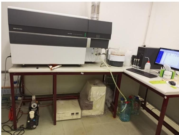
**Figura A3:** Espectrômetro de emissão óptica com plasma acoplado indutivamente (ICP-OES) *SHIMADZU* modelo 9800.
