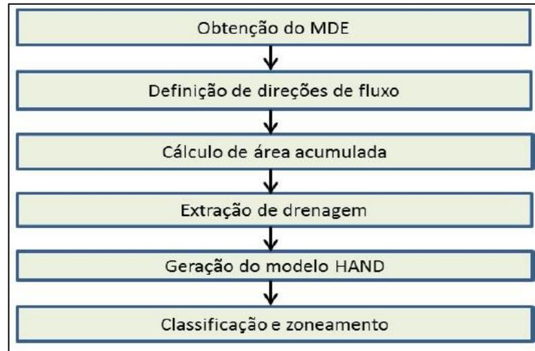
Figura 5. Fluxograma para geração da suscetibilidade a inundações segundo modelo HAND. (Fonte: Bitar, 2014).
