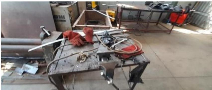
*Figura 24: Material de Soldadura mal-arrumado*
