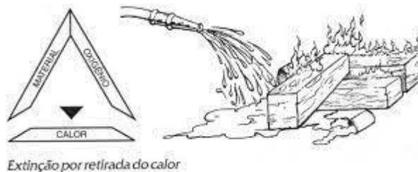
*Figura 2: Extinção por resfriamento*
