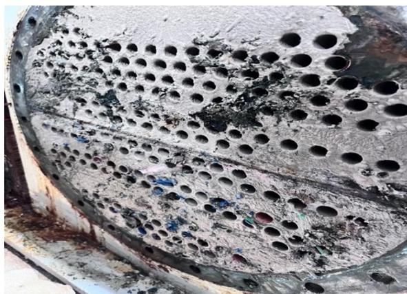
Foto 8: Calcário no trocador de calor.
