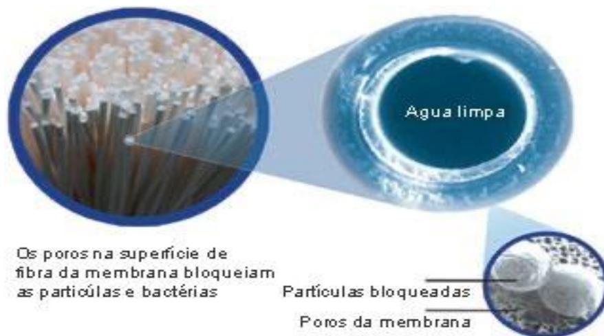
Figura 2: Membrana Osmótica Modulo Fibra Oca.
