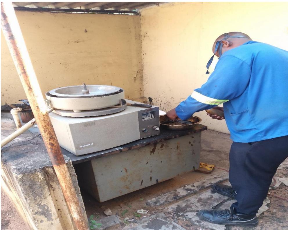
Figura 82: Ensaio para determinação do teor de Betume pelo método de centrifugação realizado pelo LEM.
