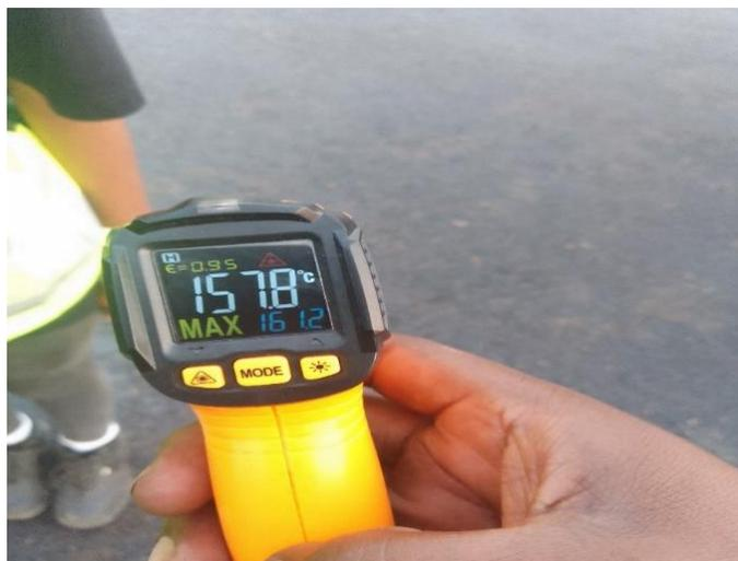
*Figura 38: Controle de temperatura dos asfalto pelo LEM.*
