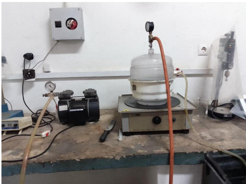
*Figura 81: Equipamento para a realização do ensaio de baridade teórica máxima.*
