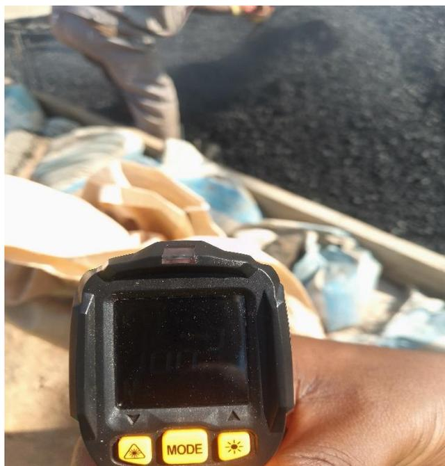
Figura 35: Controle de temperatura durante a colocação do material na área de trabalho pelo LEM.
