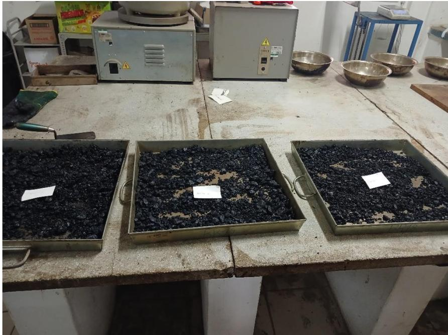
*Figura 80: Amostras de misturas betuminosas recolhidas na obra de 25 de Junho para serem ensaiadas pelo LEM.*
