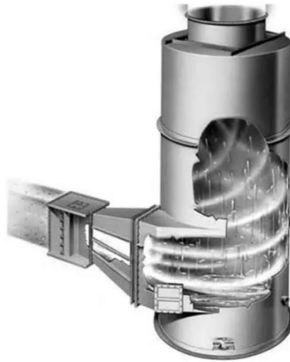
Figura 11. Câmara de recolha de gotas do tipo ciclone (Fonte: www.directindustry.com )
