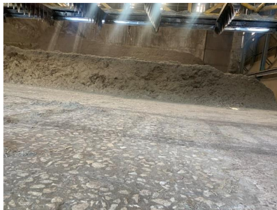
Figura 2: Bagaço depois da secagem, pronto para ser transportado para a caldeira (Fonte: Autor).
